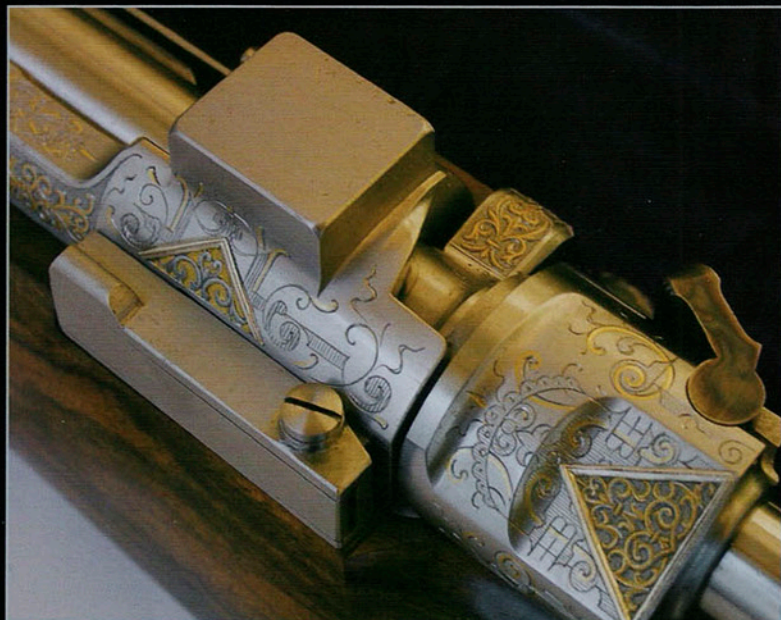
Rifle de cerrojo sobre la base de un M-98 con la nuez y seguro propio de Peter Hofer. Sobre los anillos de la acción, muestra mesas planas para los montajes del visor.
